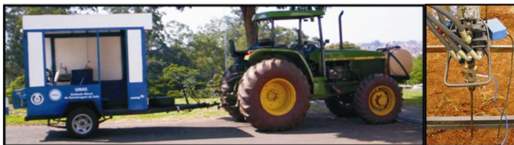
Figura 1. Vista lateral da UMAS e vista detalhada do penetrômetro.
